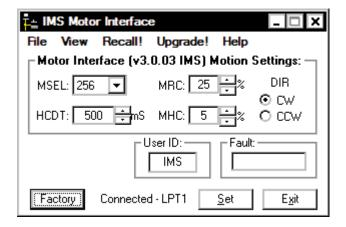
Figure 5.8 SPI Motor Interface parameter setup dialog
